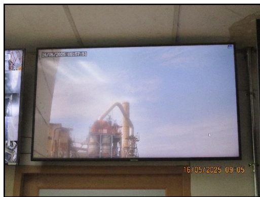
ภาพที่ 2.2 ภาพกล้องวงจรปิดเพื่อสังเกตปลายปล่องหม้อเผาและระบบคอมพิวเตอร์ควบคุมภายในห้องควบคุมการผลิต (CCR)
